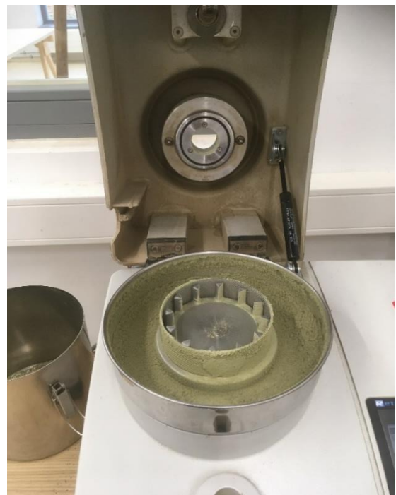
Abbildung A 4: Ultra-Zentrifugalmühle für die 2. Mahlstufe auf \leq 0,2 mm
