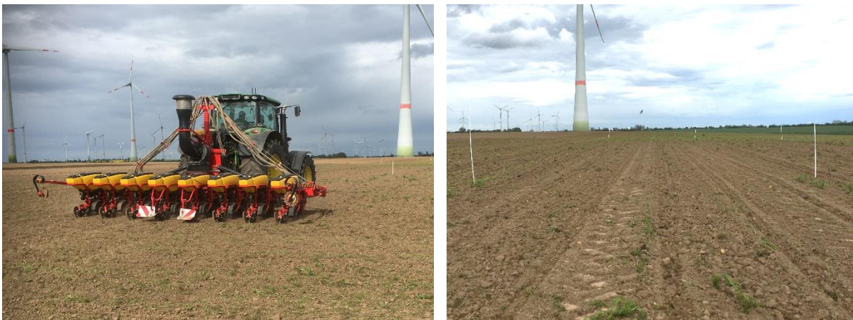
Abbildung 7: links: Körnermaisaussaat mit Väderstad Tempo (Aufnahmedatum 22.05.2021) rechts: Ablage der Saat in gelockerten Strip-Till-Reihen
